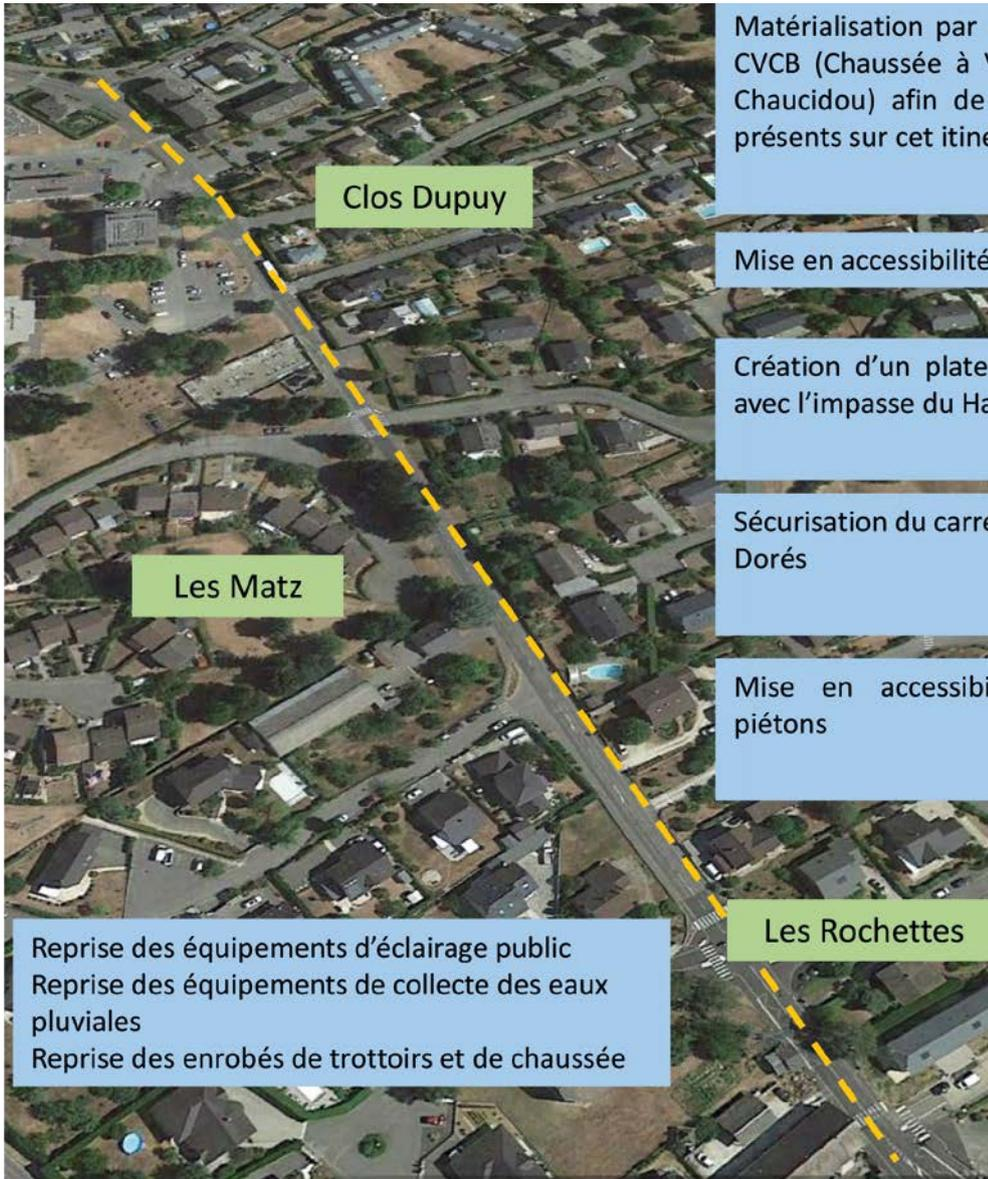
Matérialisation par du marquage au sol d'un CVCB (Chaussée à Voie Centrale Banalisée - Chaucidou) afin de sécuriser les flux cycles présents sur cet itinéraire
